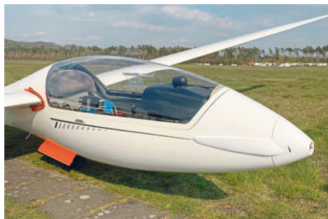
Der anliegende Faltpropeller zeigt es: Dieses Segelflugzeug (LS-8e) des Herforder Vereins hat jetzt einen Elektromotor.
