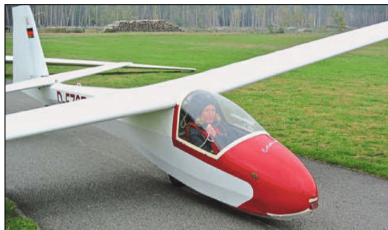
Sonja Fischer im »fliegenden Denkmal« des HVFL: Die K-8B aus dem Jahr 1960 ist noch ganz aus Holz und Stahl gebaut.
